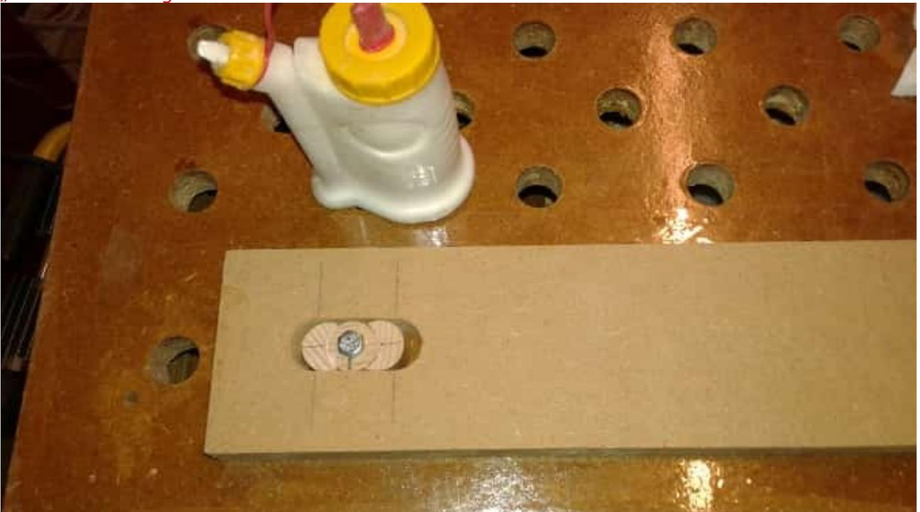
Längsführung angeleimt (und nach dem Trocknen noch verschraubt)...
