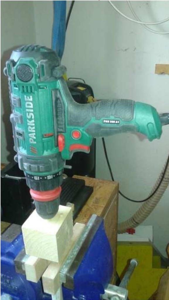
Vorborenen für die Einschlagmutter und einkleben mit Epoxy
