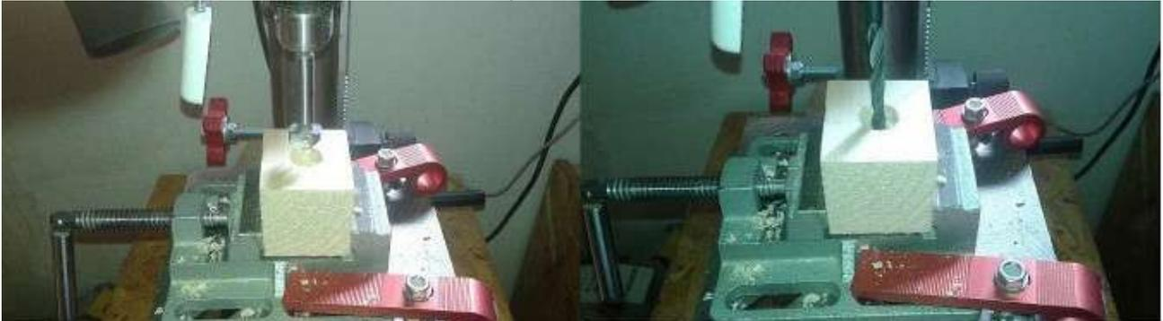
Bohren des Dübels mit 7,5mm
